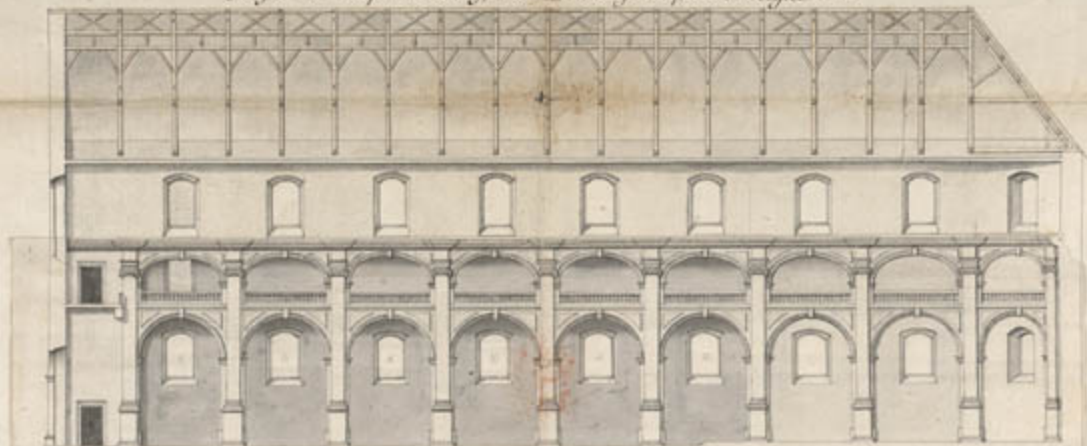
Elevation sur la Longueur de la nef qu'on pourra faire en plâtre.
